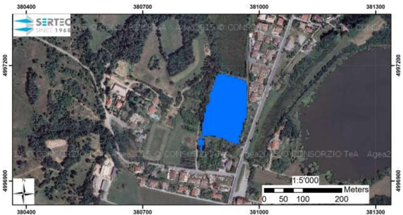
Figura 30: Quota DTM lidar regione pari a 370.7 m s.l.m., si evidenzia la perfetta corrispondenza con il perimetro del lago da ortofoto AGEA 2015.
