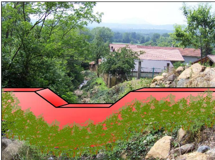
**Figura 25 - Tratto in cui potrebbe essere realizzata un'opera di trattenuta del materiale solido lungo il torrente del bacino 13 a salvaguardia della frazione Grangiotto.**
