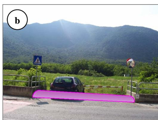
Figura 18 - Attraversamento "2" sul quale si prevede la realizzazione di un dosso artificiale di altezza minima pari a 30 cm ("a" stato di fatto, "b" ipotesi di dosso artificiale).
